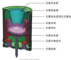
直拉单晶硅热场 (剖面图)
