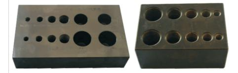
针对冷却系列产品如:喉塞,水嘴,隔水片等NPT外螺纹及装配深度,范围从1/8~3/4对应进行检测。
