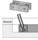
斜顶杆一端只需加工一常规螺孔,通过一个杯头螺丝简单固定,安装方便,适用范围广。
