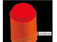
根据模具结构,水口大小尺寸及空间状况,油缸采用标准(D16)的,切刀及刀座则非标设计订制。
